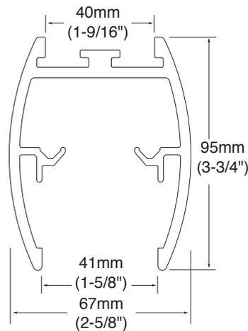
**Kopfschiene für 10mm Glas oder 6mm (1/4") Glas**
