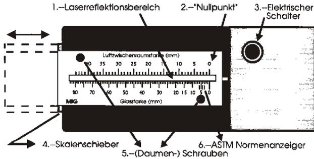
**1. Laserreflektionsbereich:** Wenn der Laser eingeschaltet ist, erscheinen die Laserstrahlen, die von der Glasoberfläche reflektiert werden, in diesem Reflektionsfeld.
