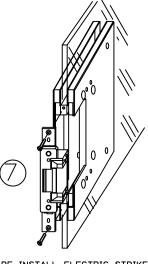
RE-INSTALL ELECTRIC STRIKE TEST FOR ALLIGNMENT WITH LOCK COMPLETE WIREING CHECK STRIKE OPERATION
