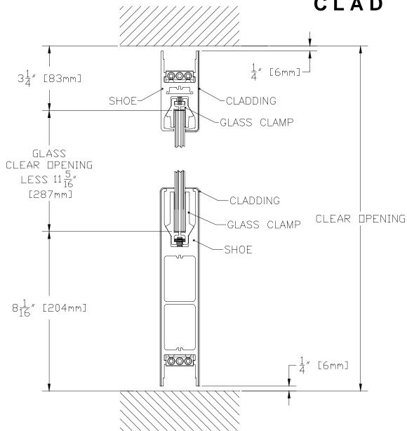
4" SQUARE DOOR RAIL TOP. CLAD OR NON CLAD 10" SQUARE DOOR RAIL BOTTOM. CLAD ONLY
