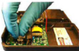
FIGURA 9: Quite la lampara vieja y reemplazala con una nueva
