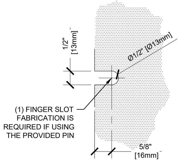
(1) FINGER SLOT FABRICATION IS REQUIRED IF USING THE PROVIDED PIN
