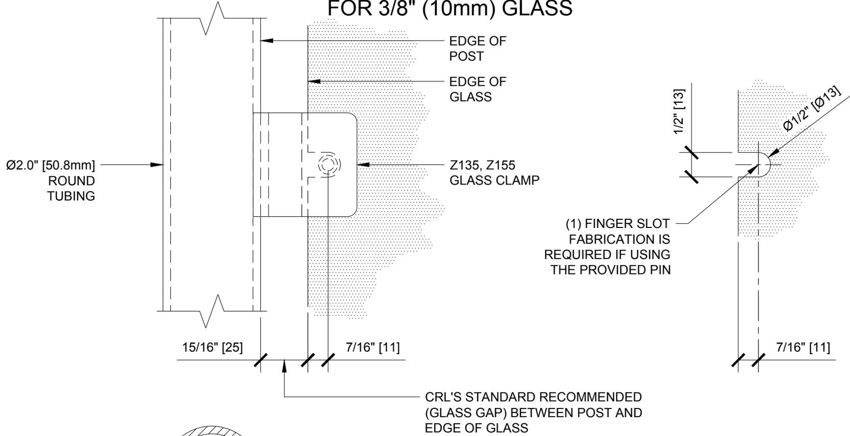
(1) FINGER SLOT FABRICATION IS REQUIRED IF USING THE PROVIDED PIN
