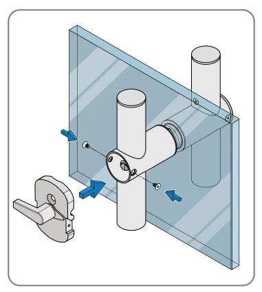
4. Insert the assembly bolt.
