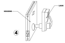
REMOVE LOCK BY SLIDING IT FROM THE HOUSING. \* SEE STEP 5. INSTALLING LOCK.
